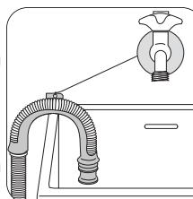
**Подвесить над краем раковины, используя пластмассовую направляющую, входящую в комплект поставки машины.** В этом случае убедитесь,
