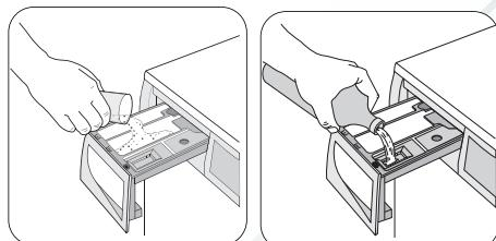
Вытяните до упора дозатор моющих средств. Отмерьте нужное количество моющего средства, засыпьте его в отделение основной стирки дозатора и, если Вы желаете выполнить предварительную стирку или вымачивание, засыпьте его в отделение, помеченное символом .
