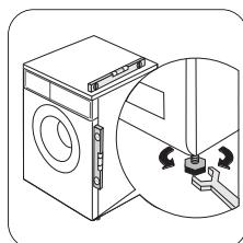
При необходимости проверьте точность выравнивания с помощью спиртового уровня.
