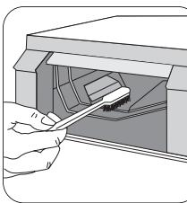
После снятия дозатора с помощью маленькой щетки прочистите отсек, в котором он находился, тщательно удалив все остатки моющих средств из его верхней и нижней части
