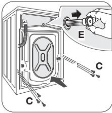
5. Снимите скобу **D**, завинтите шесть маленьких болтов **C** и снимите пластиковую шайбу **E**.
